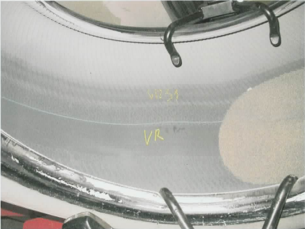
Reifen VR mit eingefülltem Wuchtpulver EASY BALANCE ohne Fehler und Mängel
