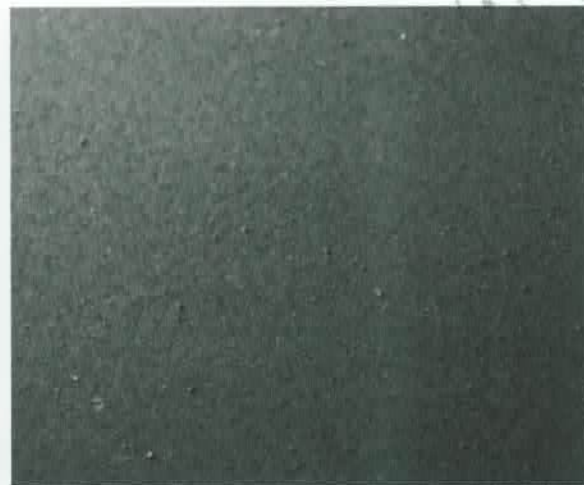
Innerliner glatt und fehlerfrei
