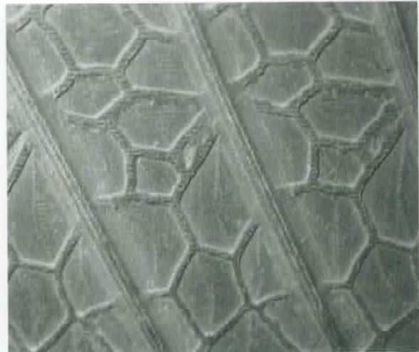
herstellerseitig einvulkanisierte Stege im Innerliner links HRI rechts HRA
