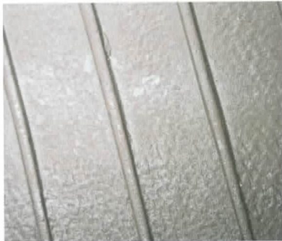
herstellerseitig einvulkanisierte Stege im Innerliner links HRI rechts HRA
