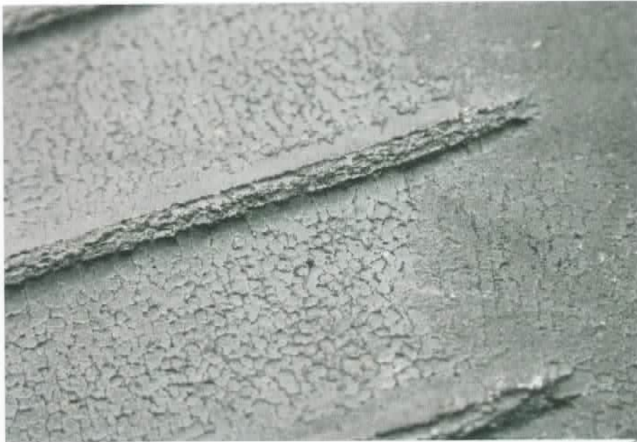
Contiinnerliner nach Versuch
