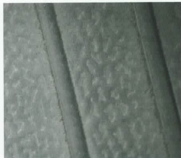
Innerliner mit glatter ausgeprägter Struktur links HLA rechts Vergleichsreifen
