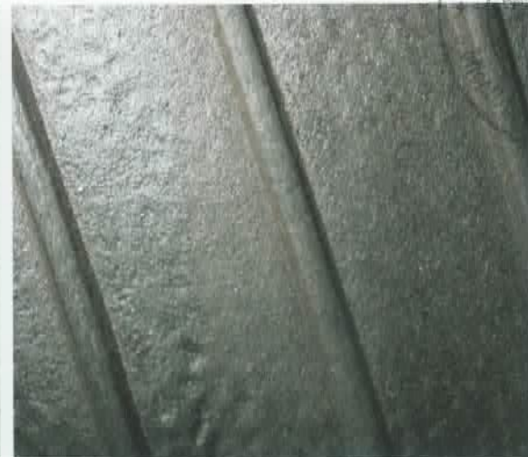
Innerliner mit glatter ausgeprägter Struktur links HLA rechts Vergleichsreifen
