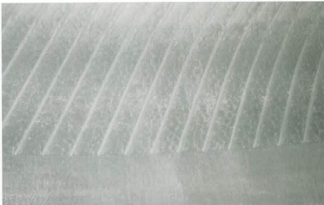
Innerliner OA X 2962, Reifen VL bei Kontrolle. Reifen Fulda, Innerliner ohne Auffälligkeiten
