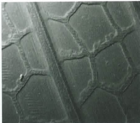
klare und fehlerfreie Oberfläche Reifen HRA Walkzone Seite ohne Mängel
