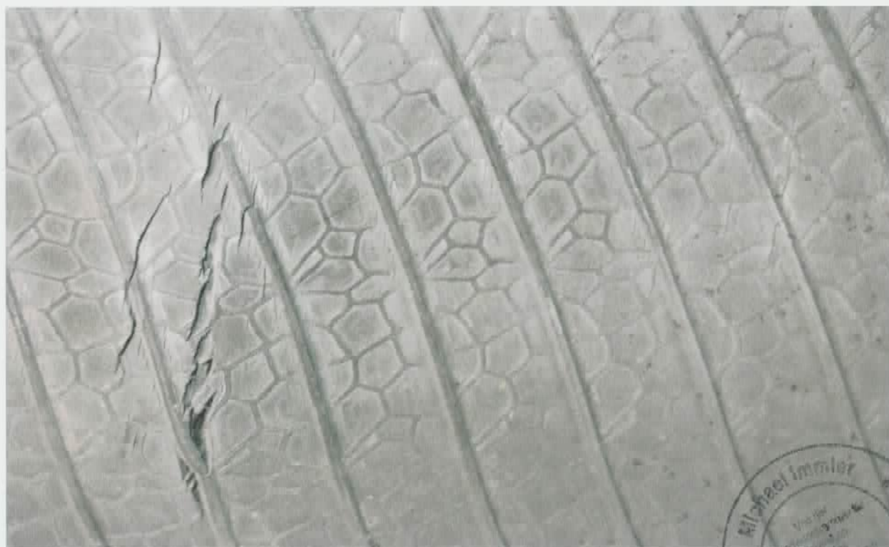
Innerliner eines Reifen Continental mit deutlichen Überlastmerkmalen. Die Leistung des Reifens und die Struktur des Innerliner sind vergleichbar. Die Restprofiltiefe ist ebenfalls vergleichbar mit der des oben abgebildeten Reifen
