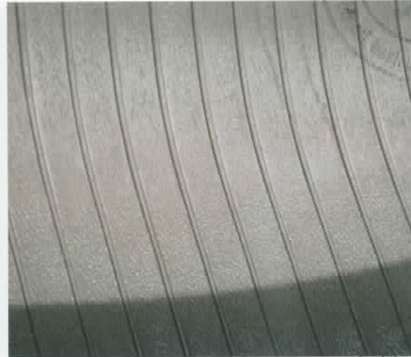
Reifeninnerliner ohne Wuchtpulver
