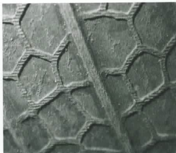
Innerlinerstruktur klar und fehlerfrei
