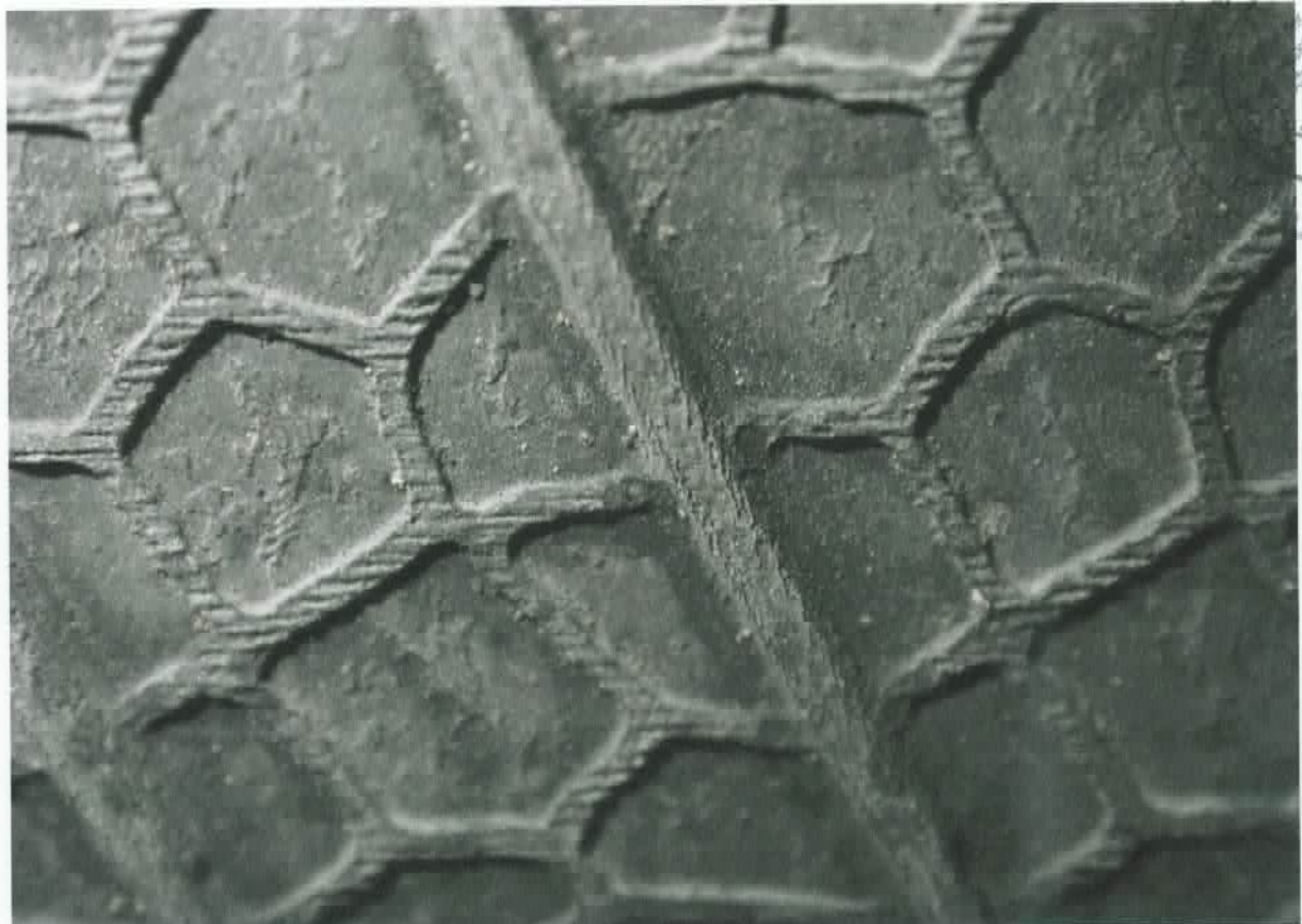
Innerliner VR nach der Demontage
