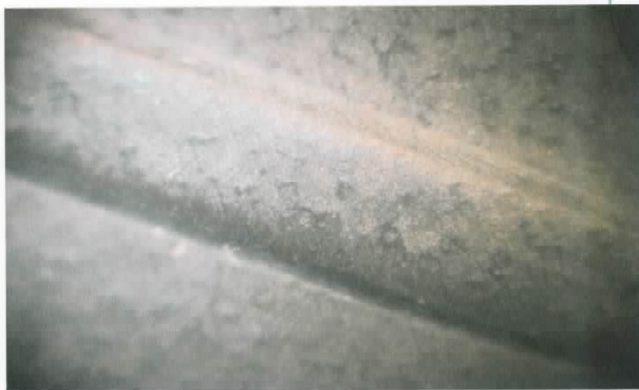
Innerliner mit Wuchtpulver gefahren: Struktur und Oberfläche unverändert
