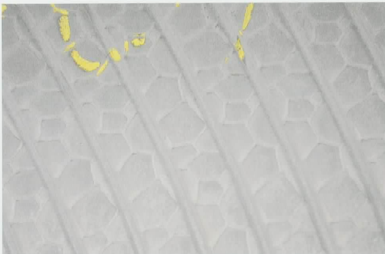
Innerliner eines Reifen Continental befüllt mit EASY BALANCE nach einer Laufleistung von ca. 49.000 Kilometer ohne Abnutzung, Fehler oder Merkmale. Der Reifen zeigt keinerlei Merkmale von Minderdruck / Überlast.
