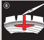
6. Schneiden Sie das überstehende Material an der Reifenaußenseite mit dem beiliegendem Messer bündig ab.
